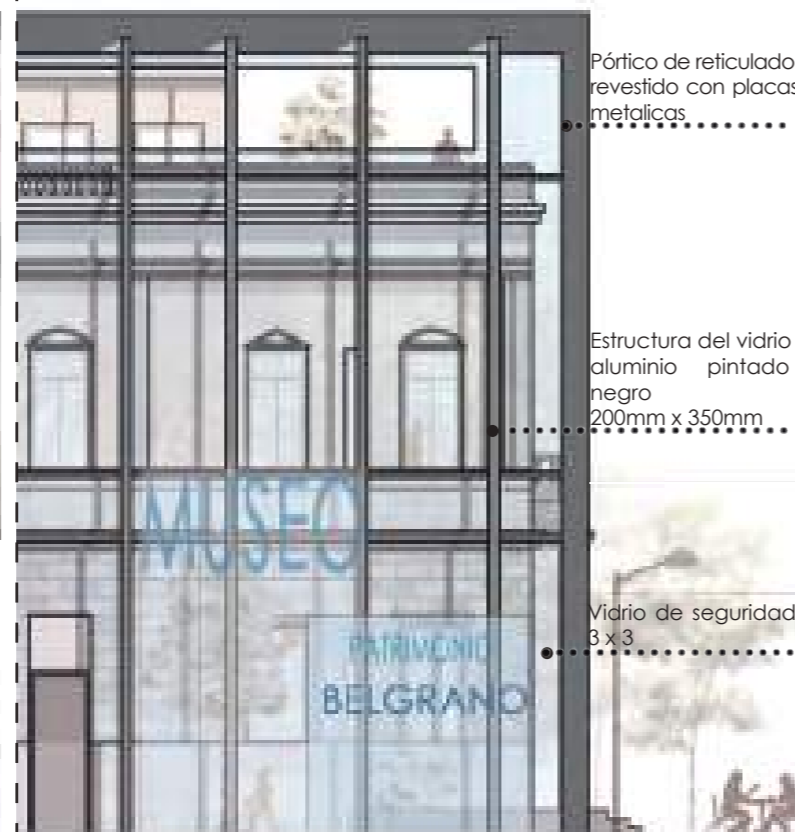
Sistema curtain-wall "STICK" con silicona
