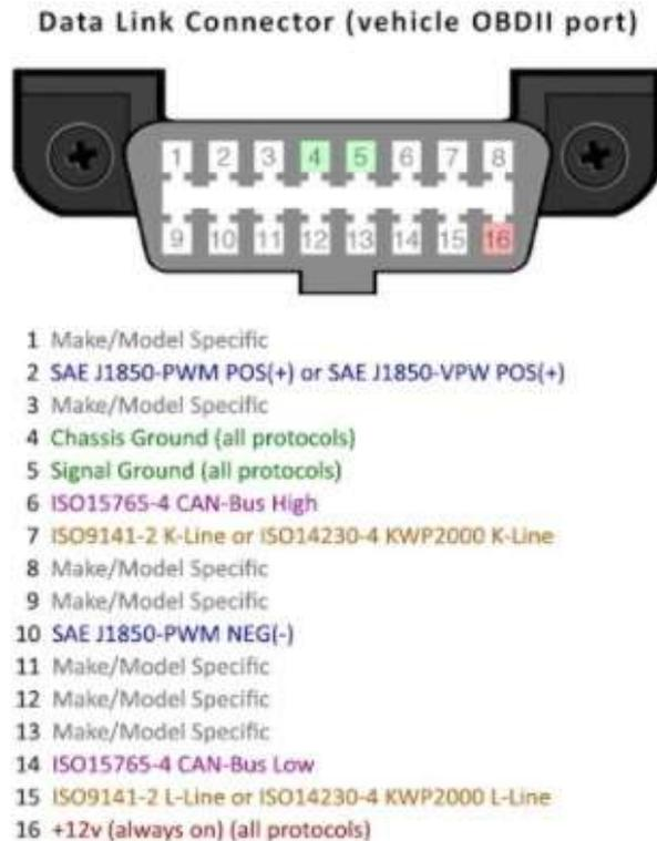
Ilustración 8. Interfaz de E/S OBDII, esquema de pinout.
