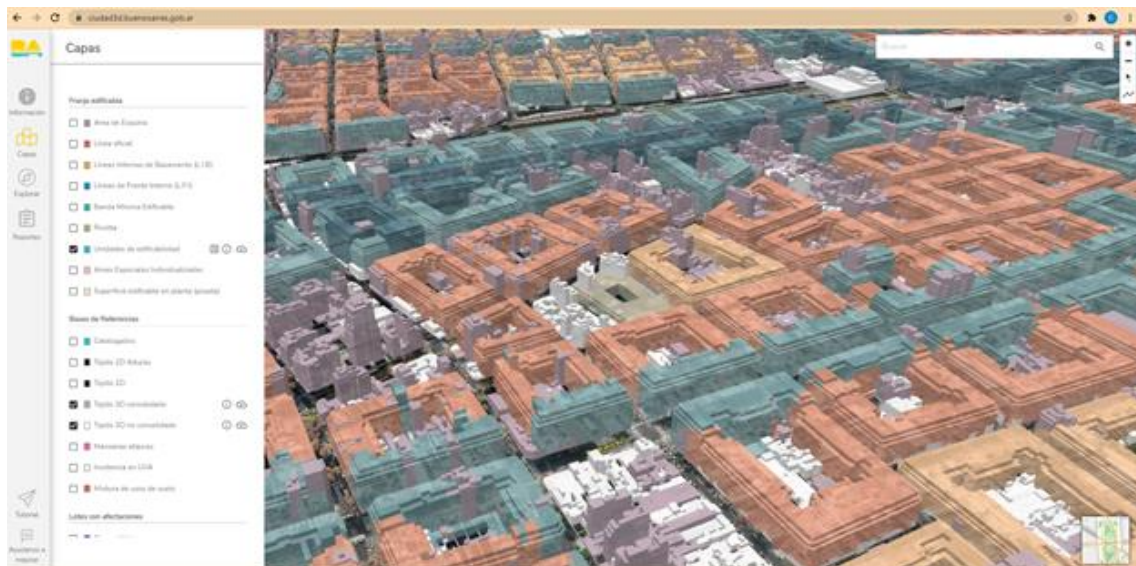
Figura 5. Ciudad 3D. Superposición de la envolvente morfológica definida en el Código Urbanístico con la morfología urbana existente.
