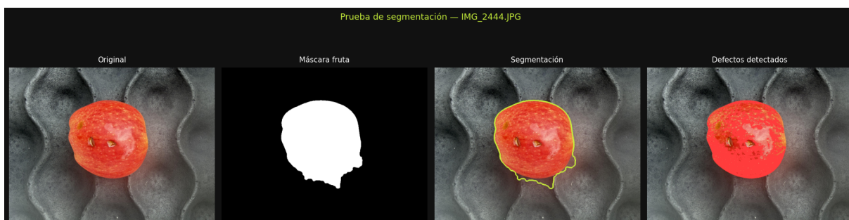
Figura 6.2. Ejemplo de fallo del Método HSV: El sistema sobreestima la superficie afectada al detectar como defecto regiones que no corresponden exclusivamente a lesiones reales, lo que evidencia la presencia de falsos positivos y limita la precisión del método.
