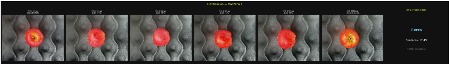
Figura 5.6. Ejemplo de clasificación de una manzana mediante múltiples fotografías.
