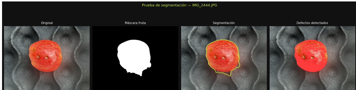
Figura 5.2. Ejemplo del proceso de segmentación HSV.
