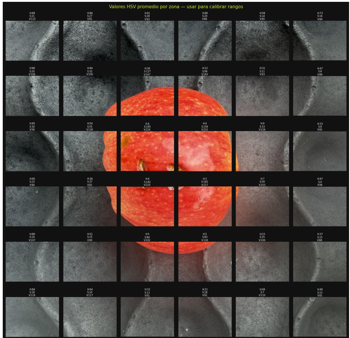
Figura 5.1. Grilla de diagnóstico HSV utilizada para la calibración de rangos cromáticos
