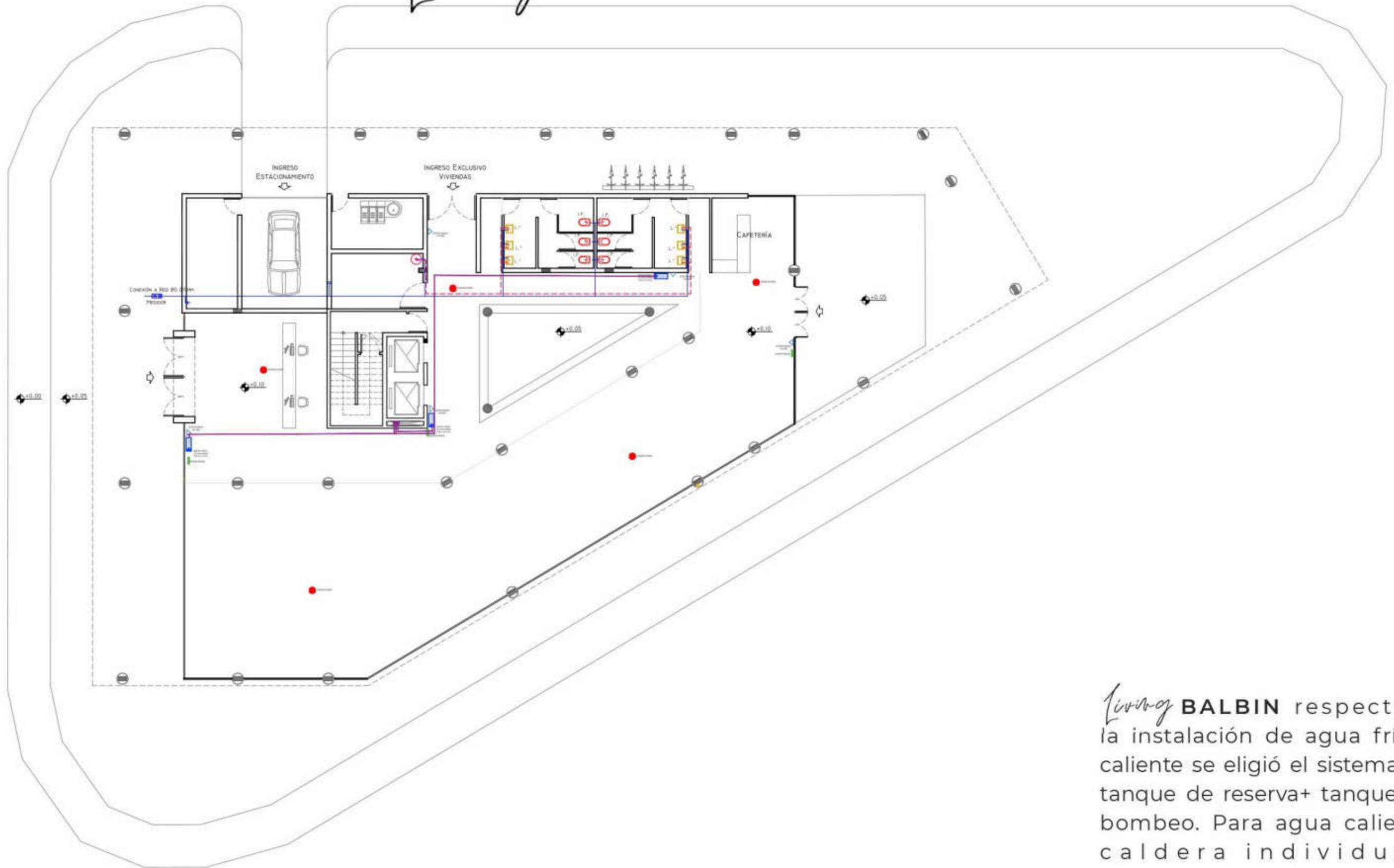
*Living* **BALBIN** respecto a la instalación de agua fría y caliente se eligió el sistema de tanque de reserva+ tanque de bombeo. Para agua caliente caldera individual.
